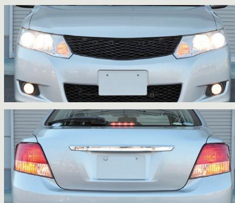
①エンジン・スイッチをONにして、ヘッドライト、テール・ランプ、ライセンス・ランプ、ブレーキ・ランプ、クリアランス・ランプ、パックアップ・ランプなどの点灯具合やウインカーランプの点灯具合及び点滅速度が不良でないかを点検します。フォグラランプ付車はフォグラランプの点灯具合も点検しましょう。
