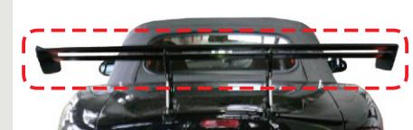
側面への翼形状を有していないこと。確実に取り付けられていること。鋭い突起がないこと。その付近の最外側、最後端ならないこと。など。
