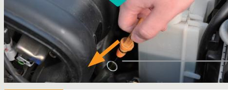
④もう一度抜いてオイルの量がオイル・レベル・ゲージの規定の範囲内(HとLの間)にあるかを確認します。
