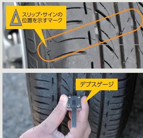
溝の深さが十分あるかをスリップ・サインなどにより点検します。なお、デプスゲージを使用すれば残り溝の深さがわかります。
