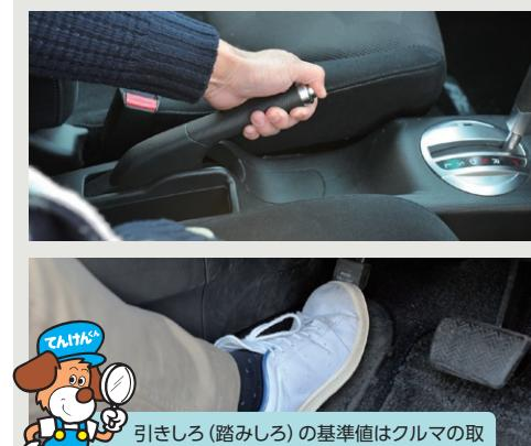
パーキング・ブレーキ・レバーをいっぱいに引いたとき、引きしろが多すぎたり、少なすぎたりしないかを点検します。また、パーキング・ブレーキがペダル式のクルマは、ペダルの踏みしろで点検します。
