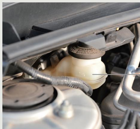
ブレーキ・リザーバ・タンク内の液量が規定の範囲 (MAXとMINの間) にあるかを点検します。
