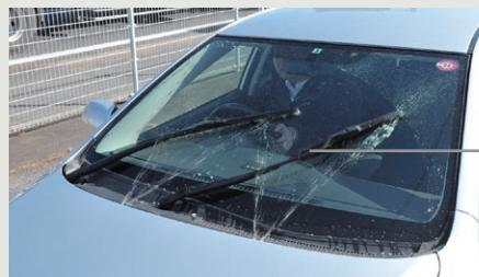
①ワイパを作動させ、低速および高速の各作動が不良でないかを点検します。
